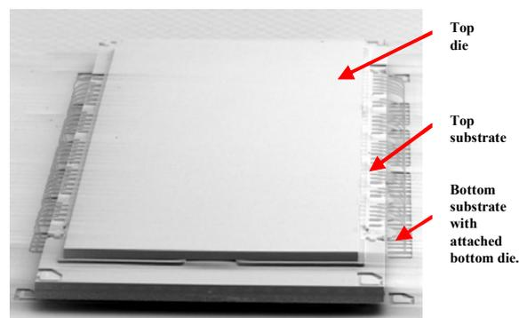
Fig. 16. SEM Photo for 2DD2-wCSP.
